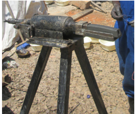
Briquettes extruded through mini extruder
